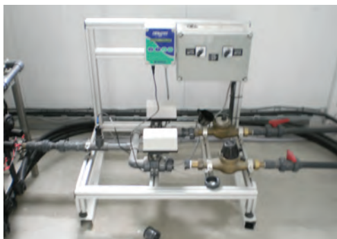
Εικόνα 1. Σύστημα ανάμειξης διαλύματος απορροής και νερού.
