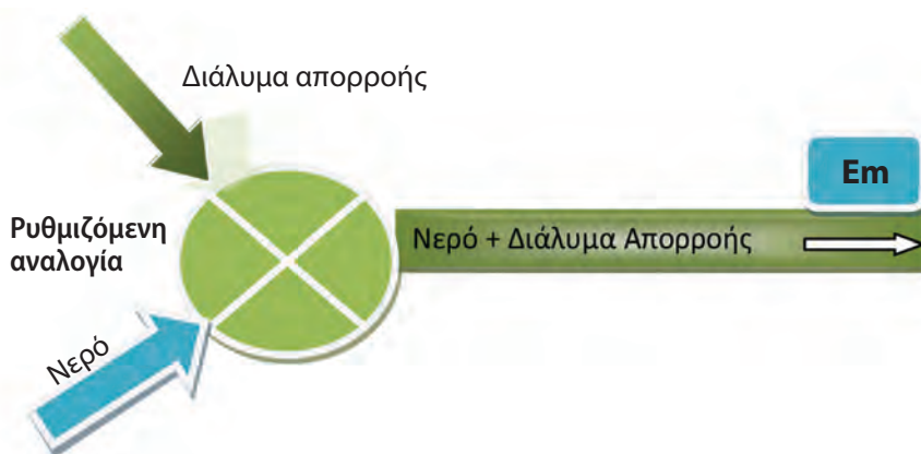
Εικόνα 3. Ανάμειξη διαλύματος απορρόης και νερού σε ρυθμιζόμενη αναλογία, για την επίτευξη μιας σταθερής και προκαθορισμένης τιμής EC ( Em ).
