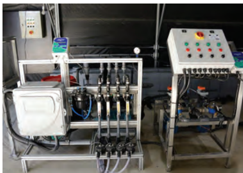
Εικόνα 1. Σύστημα ανάμειξης διαλύματος απορροής και νερού.
