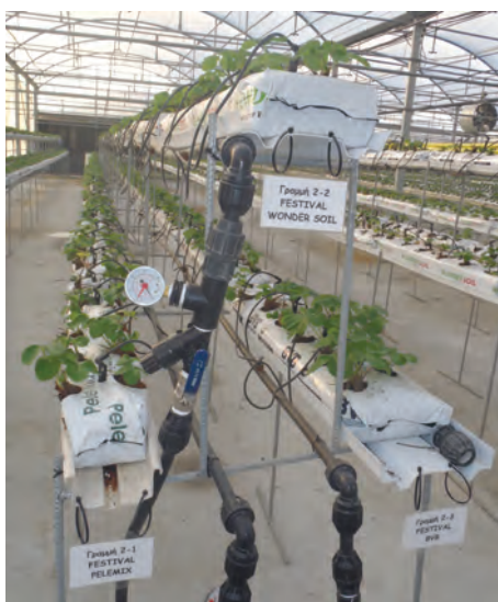
Εικόνα 4. Χρήση ρυθμιστών πίεσης και αυτορυθμιζόμενων σταλακτών σε υδροπονική καλλιέργεια φράουλας.
