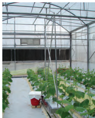
Εικόνα 1. Συνεχής παρακολούθηση και καταγραφή της μεταβολής του βάρους του υποστρώματος.
