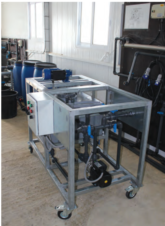
Εικόνα 1. Δοχείο πυκνών διαλυμάτων με σύστημα ανάδευσης.
